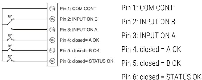
Рис. 2: Принципиальная схема порта контактов
