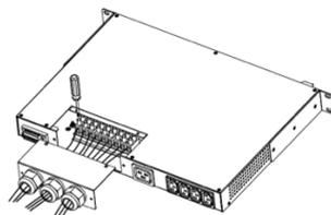
**Шаг 3:** Закрепите крышку клеммной колодки и кабельный ввод на устройстве. Затем пользователь может подключить нагрузку к выходным розеткам 10А («Выход 3») или 16А («Выход 2») в зависимости от задачи.
