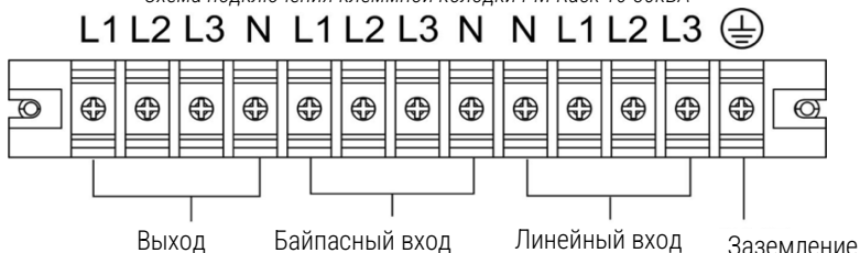
Схема подключения клеммной колодки PM Rack 40
